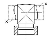
B Stumpfschweißanschluss Butt weld connection WB und W/ODS C Flanschanschluss Flange connection
