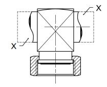
В Stumpfschweißanschluss Butt weld connection
